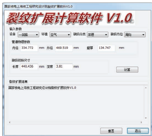
图 5 裂纹扩展计算软件界面 Fig.5 Interface of flaw growth calculation software.
